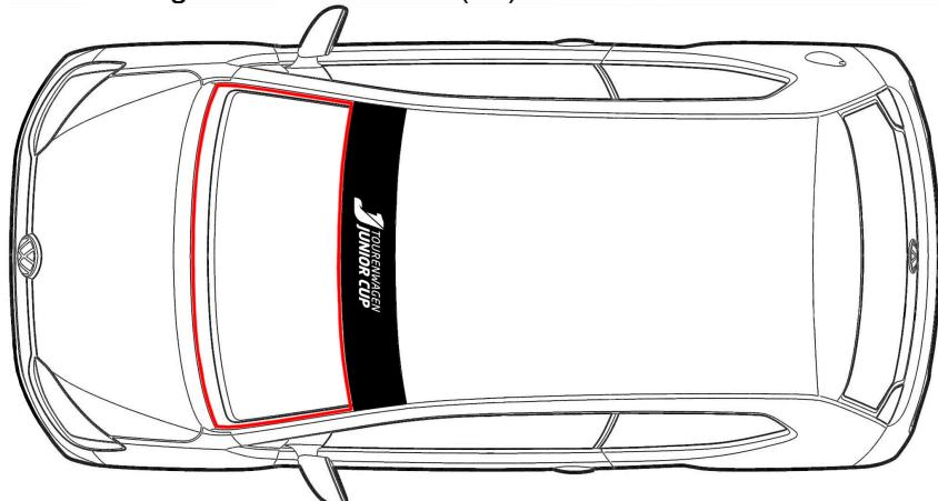
Generell dürfen Spalten an der Karosserie (z.B. Übergänge von Baugruppen, Kotflügel zu Stoßfänger oder Dachhaut zu Scheibe etc.) oder Karosserie- und Kühleröffnungen **oder die Kühler selbst** nicht mit Klebeband überklebt werden.
